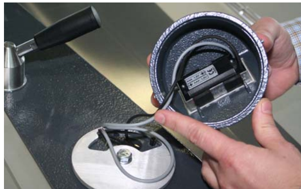
Gehäuse mit Anzeige-Elektronik entnehmen
